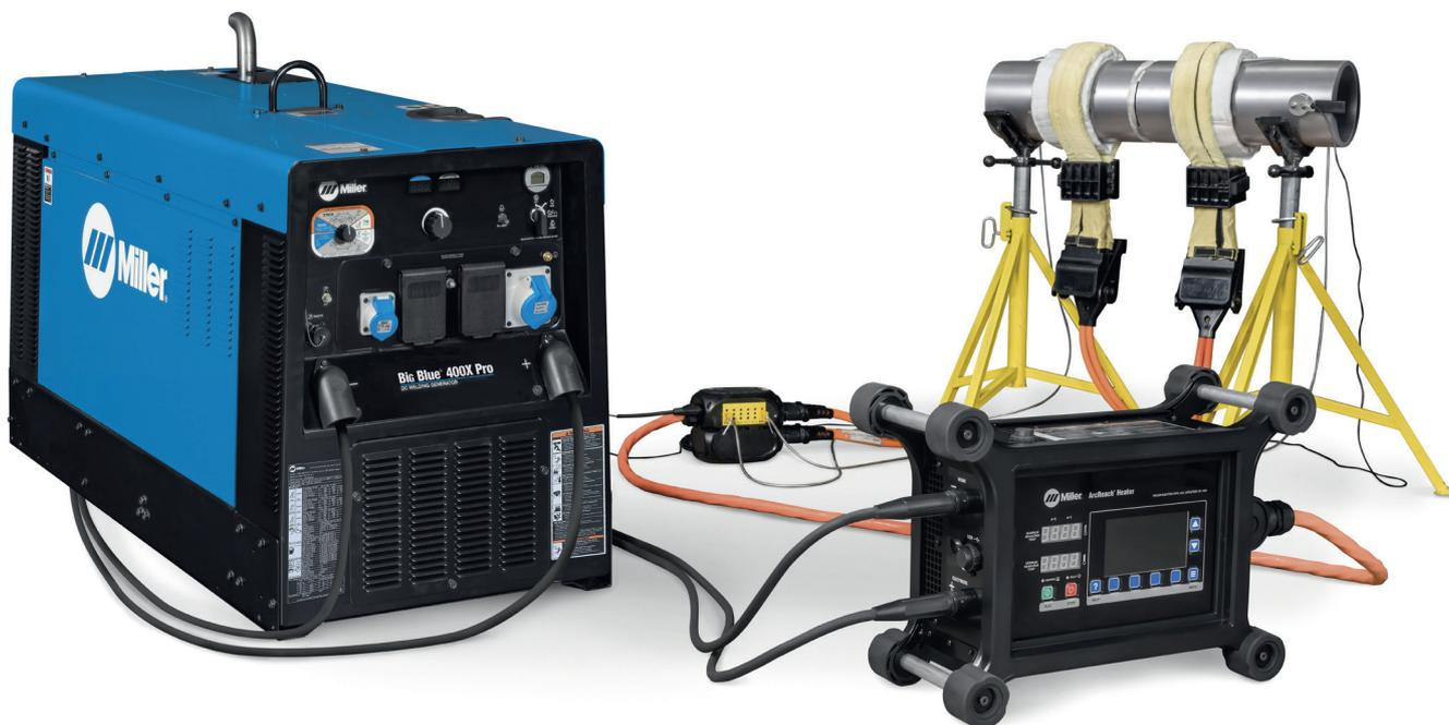
Possibilité de brancher jusqu'à six thermocouples sur le boîtier terminal du câble extension.
